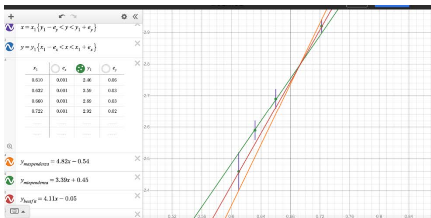
Fig. 4 – Rappresentazione digitale con Desmos delle rette di massima e minima pendenza e della retta di best fit con barre d'errore
